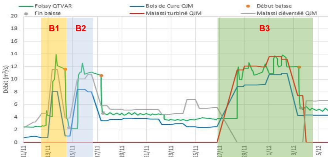
**Figure 8 : Cas de 3 baisses détectées par l'indicateur durant la période 11/11/2017 au 05/12/2017 où le débit turbiné par Bois de Cure est restitué assez fidèlement par déversement à Malassis (B1 et B2) ou par turbinage (B3).**
